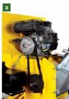
3 - EMBRAYAGE par coupleur hydraulique de sécurité. Sécurité thermique 145° Sécurité thermique 180°
