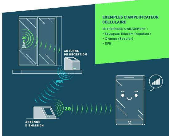
Une autre solution de couverture à l'intérieur des bâtiments peut être l'amplificateur cellulaire, agréé par chaque opérateur, afin de ne pas générer de brouillage sur les réseaux.
